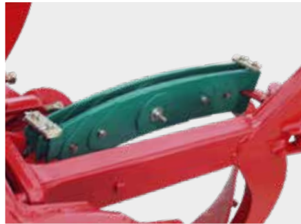
Doppeltes Federpaket mit 14 Blättern (1.400 kg)
