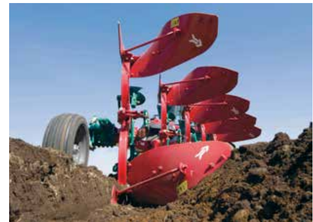
Furchenprofil Körper Nr. 28 Arbeitstiefe: 26cm, Sohle: 30cm, Breite: 73cm
