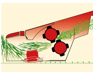
Il particolare profilo dei rulli ed il posizionamento del rullo superiore avanzato rispetto all'inferiore garantisce un costante flusso del prodotto verso lo scarico.
