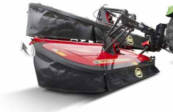
Protezione BreakAway Urtando un ostacolo l'unità di taglio si solleva arretrando per poi tornare nella posizione originaria una volta oltrepassato lo stesso.
