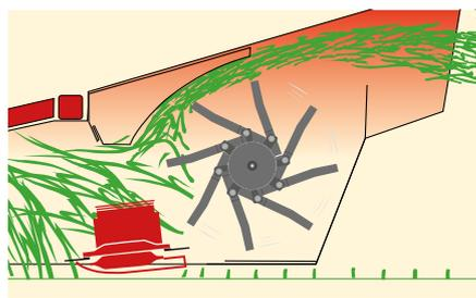
Durante il funzionamento i denti restano in posizione fissa, garantendo un condizionamento completo con usura minima.
