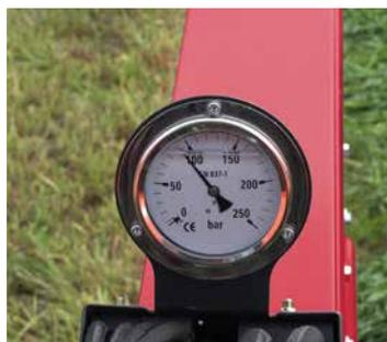
La separazione dei rulli ad azionamento idraulico permette di impostare la pressione e la distanza dei rulli senza sforzo (opzione).
