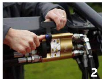
2 Scollegare il cavo di alimentazione e tutti i collegamenti idraulici al raggruppatore BX con un'unica leva.
