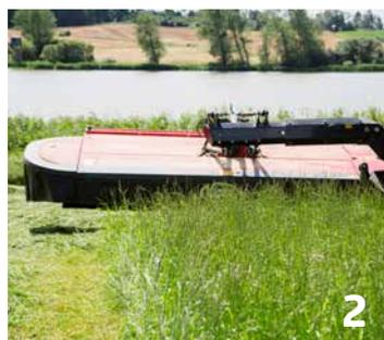
L'unità di taglio si inclina automaticamente di 10°. Il braccio riporta la macchina in modo perpendicolare al terreno pronta per il lavoro.
