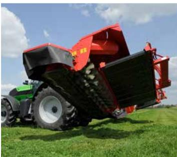
Con la EXTRA 690T ISOBUS è facile eseguire le manovre in testata. Ogni unità viene sollevata indipendentemente tramite comando dalla centralina di controllo.
