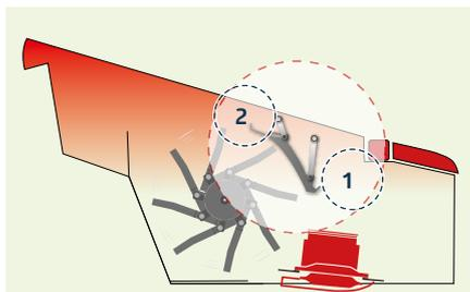
L'estremità anteriore e posteriore è completamente chiusa, per un condizionamento in condizioni di scarso raccolto.
