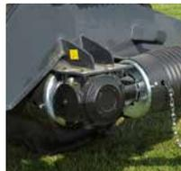
Variazione della velocità della scatola di trasmissione da 540 a 1000 giri/min.
