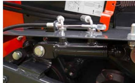
Con il cilindro idraulico opzionale, la pressione e la distanza dei rulli è facilmente monitorata.
