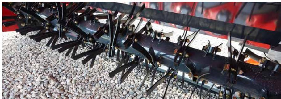
Una volta nella posizione di lavoro, il dente va in appoggio sul rotore assicurando grande motricità.
