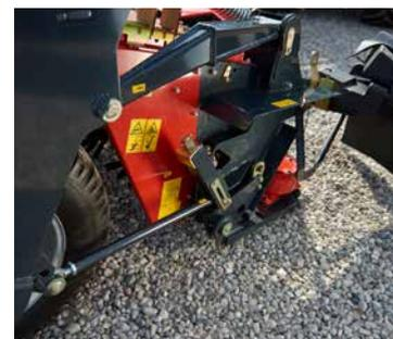
Le speciali aste assicurano che la sezione di taglio si alzi automaticamente e passi sopra l'ostacolo.
