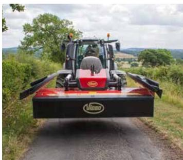
Ripiegamento idraulico delle protezioni FlexProtect (opzionale).
