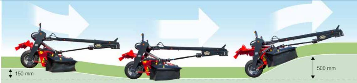
Le molle di sospensione permettono alla falciatrice di seguire perfettamente il terreno in ogni condizione. La sezione di taglio si può adattare da 500mm a 150 mm.
