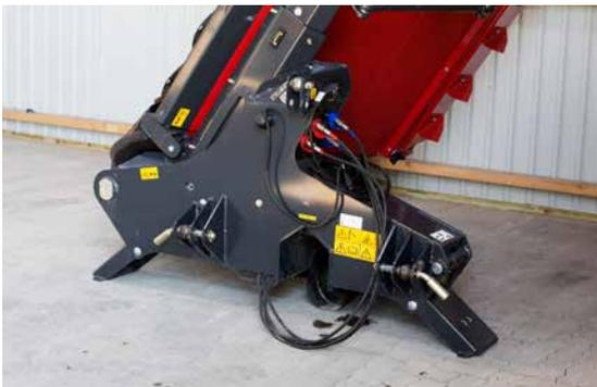
Il particolare sistema di parcheggio permette l'accoppiamento o disaccoppiamento della macchina in modo molto veloce.
