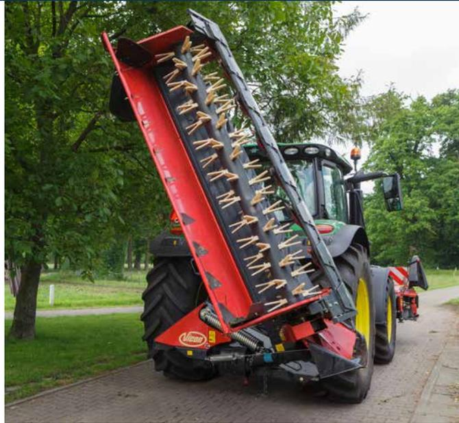
Le EXTRA 624T, 628T/R o 632T Farmer si chiudono verticalmente a 125° in posizione di trasporto tramite un cilindro idraulico.
