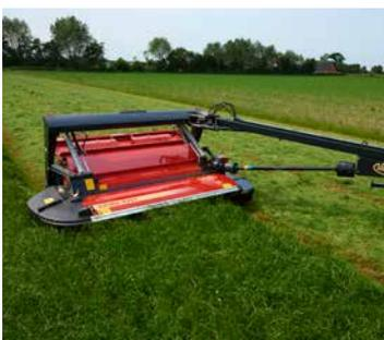
Telaio fisso e numero ridotto di parti mobili - minor usura e manutenzione.
