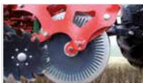
Les disques coupeurs frontaux ouvrent le sol et coupent les longs résidus qui peuvent être facilement retirés par les chasses débris rotatifs.
