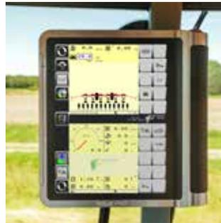
Con il sistema e-drive II ogni unità di semina è azionata individualmente da un motore elettrico. Tutti i parametri sono inseriti e letti tramite un terminale ISOBUS come IsoMatch Tellus GO e PRO. La distanza sulla fila è infinitamente regolabile in movimento. Tutte le unità di semina possono essere avviate/arrestate individualmente. Questa soluzione riduce la quantità di seme sprecata e dunque i costi!
