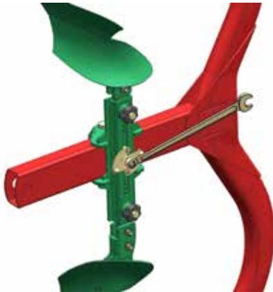
Für perfektes Pflügen ist das Anpassen der Arbeitstiefe an den Vorwerkzeugen unerlässlich. Falsche Einstellung der Einleger bewirkt, dass Ernterückstände nicht optimal in den gepflügten Boden eingearbeitet werden. Die neue Lösung trägt zu mehr Effizienz beim Pflügen bei.
