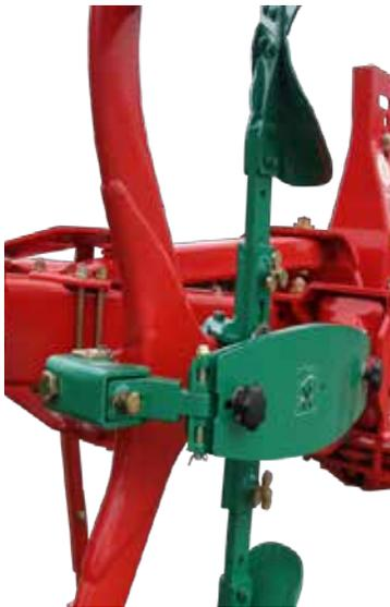
Der Kverneland 2500 i-Plough® ist mit neu gestalteten Grindeln ausgerüstet, welche ein so genanntes „Aero-Profil“ aufweisen. Nicht nur durch die im Vergleich zum bisher bekannten Grindel größere Höhe verbessern diese neuartigen Grindel den Erdfluss beim Pflügen. Große Mengen an Pflanzenresten können ungeachtet des Körperabstandes von 85, bzw. 100 cm einfach passieren.
