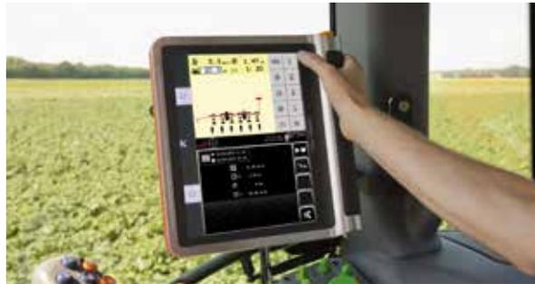
Mit e-drive II wird jede Säreihe individuell über einen Elektromotor angetrieben. Dank ISOBUS werden die Daten in der Schlepperkabine auf dem Terminal ausgegeben. Die Kornabstände können vom Terminal stufenlos eingestellt und während der Aussaat verändert werden. Jede Säreihe wird individuell ab-/angeschaltet, so dass Betriebsmittel und somit Geld einspart werden.
