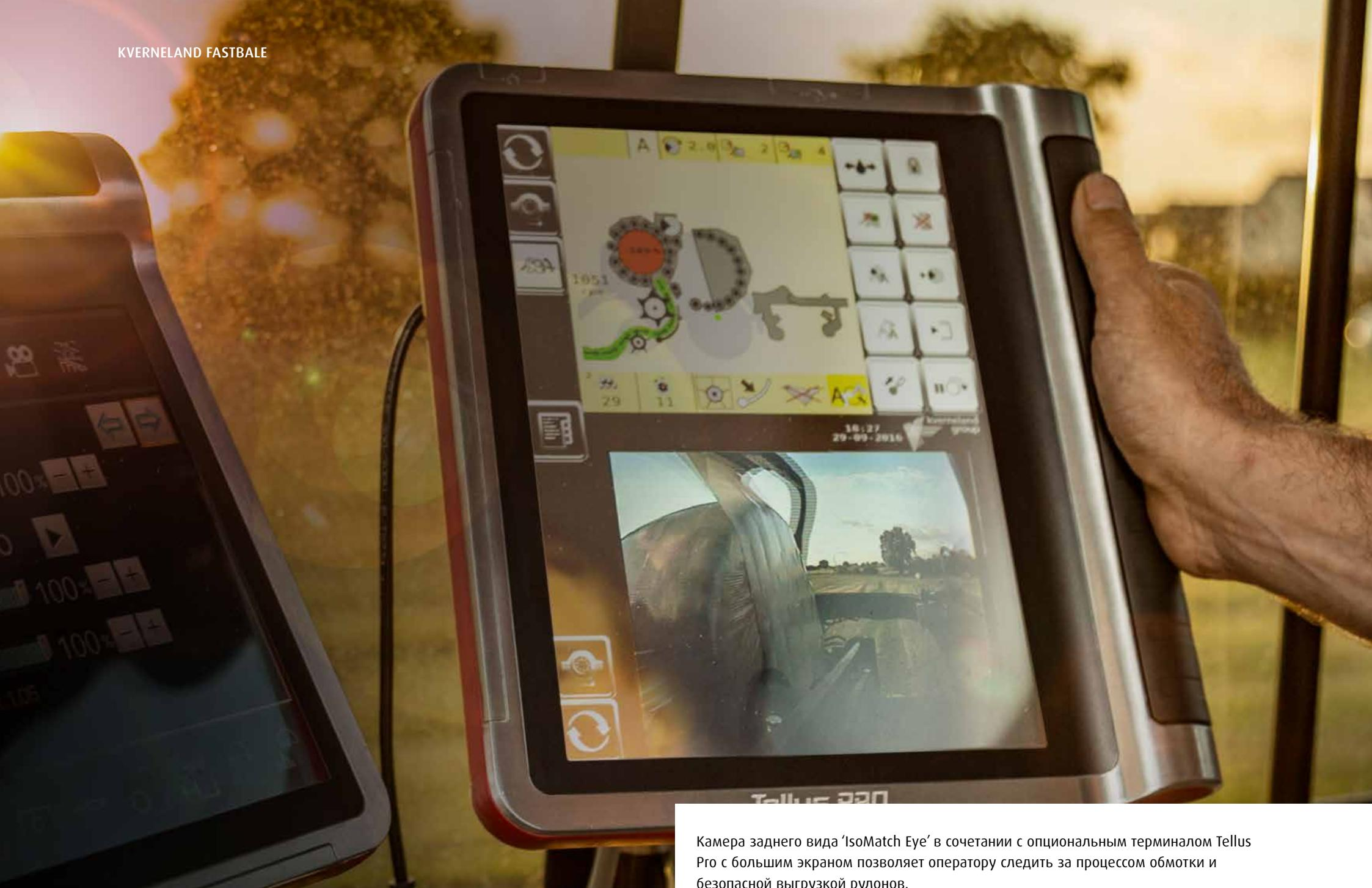
Камера заднего вида 'IsoMatch Eye' в сочетании с опциональным терминалом Tellus Pro с большим экраном позволяет оператору следить за процессом обмотки и безопасной выгрузкой рулонов.
