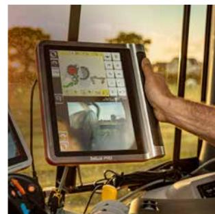
FastBale полностью совместим с ISOBUS в стандартной комплектации и может работать на любом тракторе, оснащенном ISOBUS, без необходимости установки дополнительного терминала.
