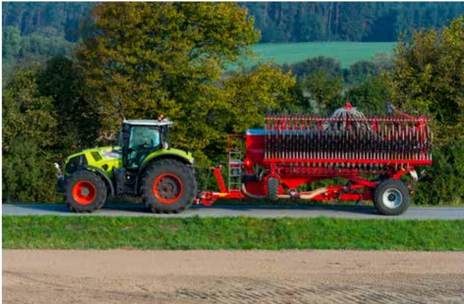
Sur la route, grâce à ses roues de 800 mm de largeur, le DG II dispose d'une très bonne stabilité. Avec une largeur de 3 mètres et une hauteur de 4 mètres, ses dimensions sont dans des normes de réglementation de circulation européennes.
