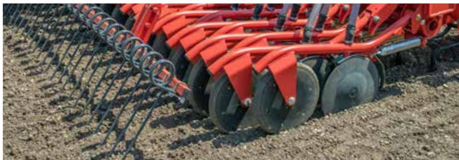
L'élément semeur CD dispose d'un angle d'attaque très réduit afin d'éviter les projections de terre et atteindre la bonne profondeur de semis. Ainsi, la pression peut être appliquée sur la roulette plumbeuse si nécessaire.
