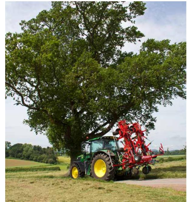
Dimensions compactes au transport de 85112 - la hauteur de stockage est de seulement 3,80 m.
