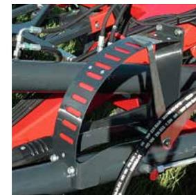
Le réglage hydraulique de la hauteur est disponible en option et contrôlé par un double effet supplémentaire. Le réglage de la hauteur est facilement lisible depuis la cabine, facilitant ainsi le réglage correct de la machine.
