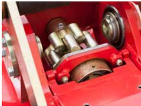
Entraînement à doigts Kverneland HexaLink permettant un repliage au transport à 180°.
