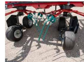
L'entraînement Kverneland HexaLink permet un repliement à 180° des rotors extérieurs au transport.
