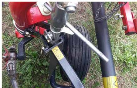
La roue de jauge en option permet un suivi encore plus précis du sol pour un meilleur fanage.
