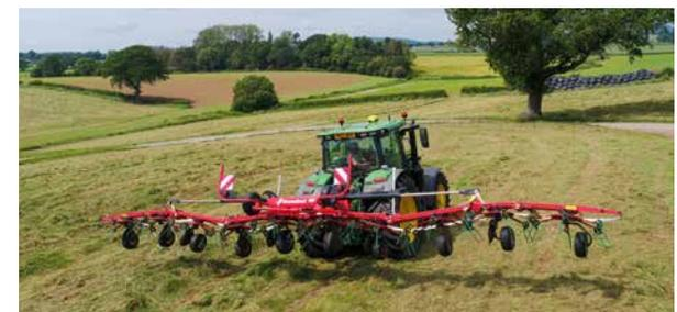
Le kit fourrière hydraulique en option stabilise parfaitement la faneuse pendant les manœuvres.
