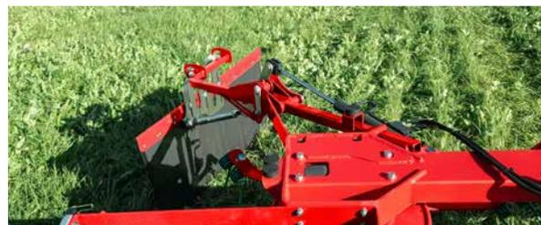
Une planche à andain hydraulique permet de maintenir la récolte dans la largeur de travail de la machine (option).
