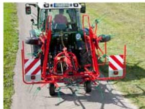
Repliage hydraulique entre la position de travail et la position de transport.
