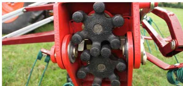
La Kverneland 85112 est équipée de la nouvelle version XL de l'entraînement à doigts HexaLink assurant des transferts de puissance fiables et un repliement à 180° des rotors extérieurs pour le transport.
