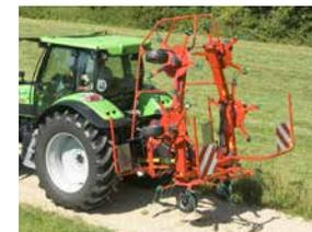
La Kverneland 8460 se replie hydrauliquement de la position de travail à la position de transport.
