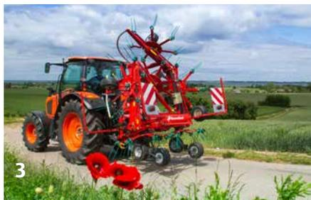
1. L'entraînement à doigts Kverneland HexaLink permet un repliement à 180° des rotors extérieurs pour le transport. (Kverneland 8576 et 8590)
