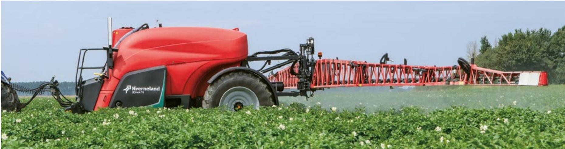
La barra de pulverización de HSS combina un mínimo de peso con un máximo de fuerza y estabilidad. El acero especial Domex endurecido le da a esta barra de pulverización una reputación de alta calidad y de larga duración. El sistema de unión en lugar de soldadura de la gama de barras de pulverización de aluminio HSA proporciona un ahorro de peso y una notable resistencia.
