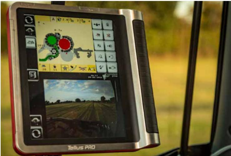
La telecamera posteriore "IsoMatch Eye" accoppiata all'ampio doppio schermo del terminale IsoMatch Tellus Pro (disponibile a scelta) permette all'operatore di tenere sott'occhio il processo di fasciatura ed lo scarico della balla.
