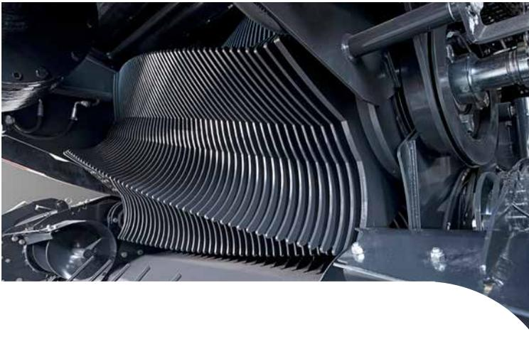
Equipaggiata con infaldatore a 50 denti in Hardox®, la FastBale ha una produttività senza rivali. Il posizionamento ravvicinato di pick-up ed infaldatore riduce le perdite anche quando in presenza di prodotto corto.
