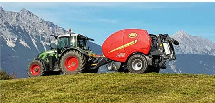
L'innovativo sistema di fasciatura ne eleva la caratteristica di compattezza. Durante il trasporto, il fasciatore si ripiega in posizione verticale riducendo considerabilmente la lunghezza generale. Così, anche i rulli del film sono protetti dai bracci dei satelliti. La minima esposizione della coda della macchina permette un semplice accesso anche nei campi e passaggi più stretti.
