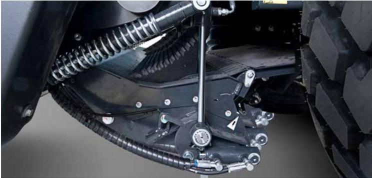
Per soddisfare qualsiasi esigenza, il sistema di taglio SuperCut con 25 coltelli permette la selezione multipla delle unità offrendo operatività con 6, 12, 13 e 25 coltelli. Il sistema anti-bloccaggio "Drop floor" permette di riprendere rapidamente la raccolta in caso di ostruzione.
