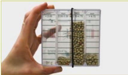
*Le granulomètre permet de mesurer la répartition des grains d'engrais*
