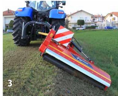
1. Böschungen Mulchen, Hecken- und Gehölzpflege mit bis zu + 90 Grad Arbeitsbereich
