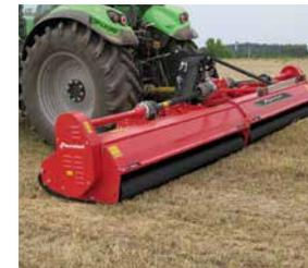
Zur einfachen Wartung und besseren Zugänglichkeit können die Mulcherhauben geöffnet werden.
