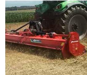
Das zentrale Getriebe verteilt die Kraft gleichmäßig auf die seitlichen Riemenantriebe.
