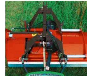
dungsfrei montierte und präzise ausgerichtete Dreipunkturm sorgt für eine starke und zuverlässige Führung. Schmierbare Nylonbuchsen sorgen für eine leichtgängige Seitenverschiebung von 500 mm.
