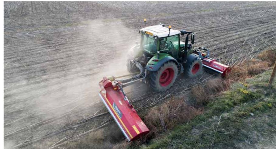
Der **extrem stabile Schwenkrahmen** und die Anfahrtsicherung mittels Öldruckspeicher garantieren Langlebigkeit und Einsatzsicherheit. Das Getriebe ist durch einen massiven Abweisbügel gegen Beschädigungen geschützt
