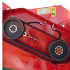
Der FXZ ist mit einem doppelten Antrieb ausgestattet. Das starke Getriebe mit integriertem Freilauf ist für Leistungen bis 260 PS ausgelegt.
