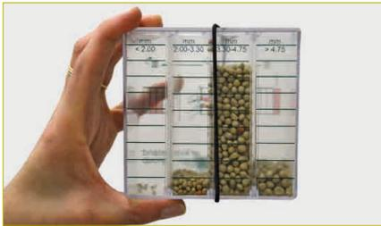
*Коробка для определения гранулометрического состава*
