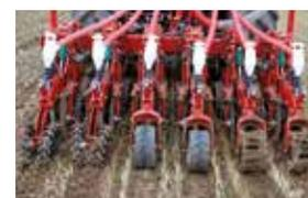
Les roulettes de rappui. Trois types de roulettes plumbeuses permettent une polyvalence totale au KultiStrip, le remplacement se fait rapidement par un seul axe.
