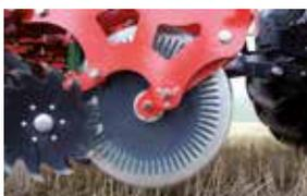
Les disques découpeurs à l'avant ouvrent le sol et coupent les résidus longs qui peuvent être facilement écartés par les chasses débris rotatifs.
