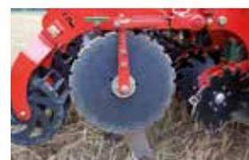
Les disques latéraux de chaque côté de la dent définissent la largeur et la forme de la bande de terre.
