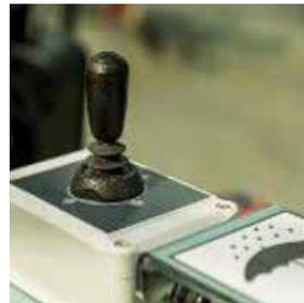
Tous les modèles électroniques sont équipés d'un joystick compact qui peut être monté sur l'accoudoir du tracteur. Il permet d'activer du bout des doigts les fonctions d'enrubannage et de déchargement de balle, mais aussi l'annulation immédiate et à tout moment d'autres fonctions.
