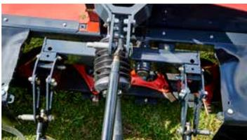
4. Die drehbare Unterlenkerschwinge erlaubt einen großen Pendelweg.
