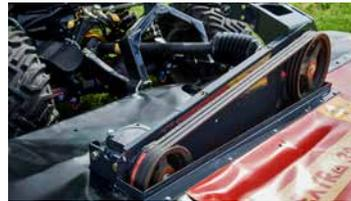
2. Der Antrieb kann durch Wechseln der Riemenscheiben von 540 auf 1.000 U/min oder umgekehrt geändert werden.
