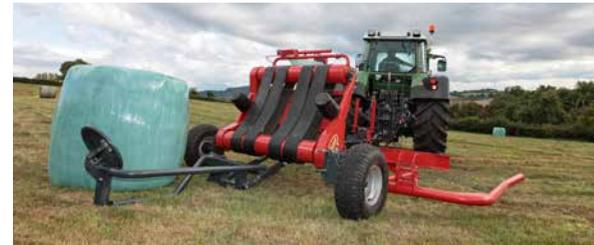
Las encintadoras con rotación de mesa Kverneland pueden estar equipadas con un volteador de pacas.
