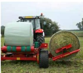
La baja altura de elevación permite una rápida transferencia de la paca.
