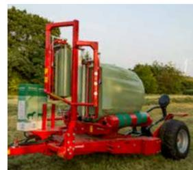
El diseño de la mesa baja permite una alta velocidad de rotación.
