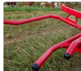
El brazo de carga ajustable permite recoger la paca y cargarla en movimiento.
