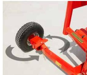
Para lograr un ancho de transporte más estrecho, la rueda derecha se gira hacia la parte interior del brazo de soporte.
