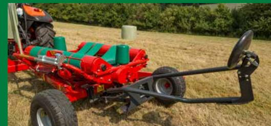
Mesa giratoria con dos rodillos accionados, diseñada para una alta estabilidad de las pacas y una rotación suave.
