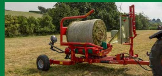
El brazo de carga accionado hidráulicamente y la baja altura de carga permiten una rápida transferencia de las pacas desde el brazo a la mesa de encintado.
