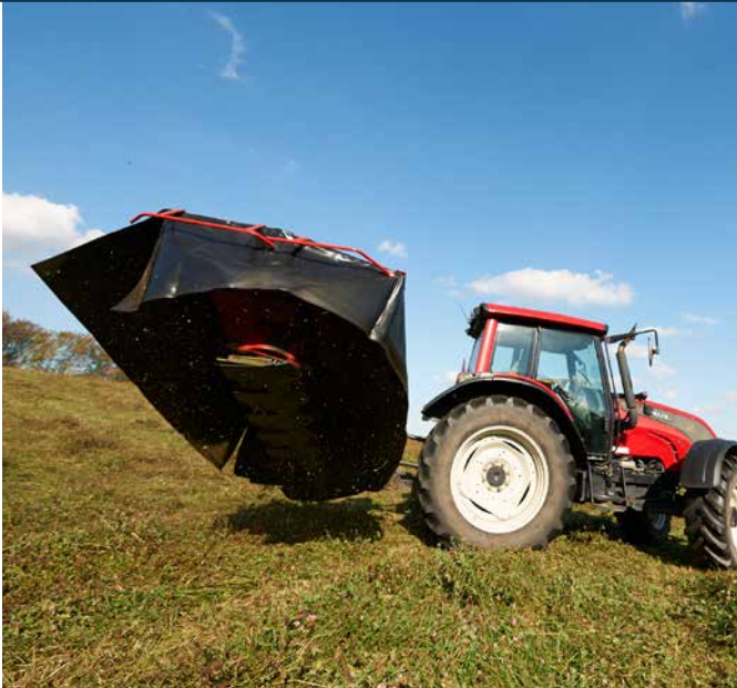
Uitheffen op de kopakker m.b.v. hydraulische cilinder.
