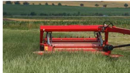
Le nouveau design des longs ressorts de suspension offre un suivi parfait des contours du terrain et assure une pression au sol constante.
