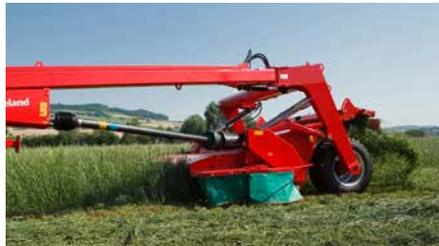
La suspension offre un excellent suivi des contours du sol et assure une pression au sol constante dans tous les conditions. La hauteur de fauche peut être ajustée de 50 cm vers le haut et 15 cm vers le bas.
