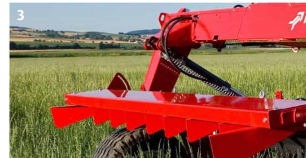
3 Démontez les deux déflecteurs intérieurs et la machine est prête pour faucher.
