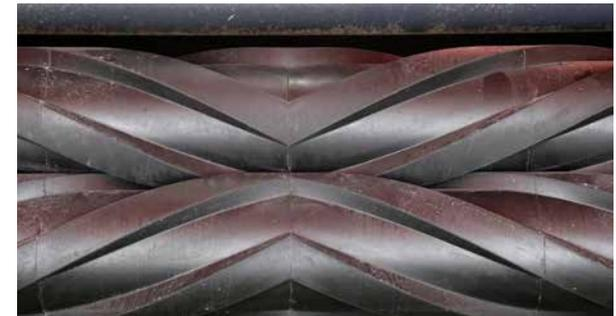
La forme Chevron des rouleaux assure un flux régulier du fourrage sur toute la largeur de fauche.
