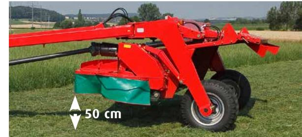
Dégagement par rapport au sol de 50 cm grâce au concept du châssis.
