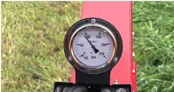
La pression et la distance entre les rouleaux est facilement réglable hydrauliquement (en option).
