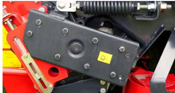
Les 2 rouleaux conditionneurs sont entraînés de chaque côté avec des boîtiers lubrifiés ne nécessitant aucun entretien.
