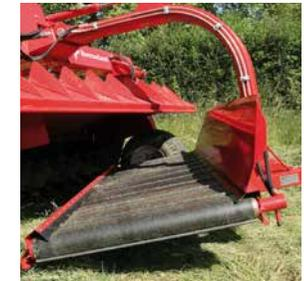
Le tapis est suspendu hydrauliquement pour réduire les contraintes sur le châssis et pour réaliser un andain le plus uniforme possible.
