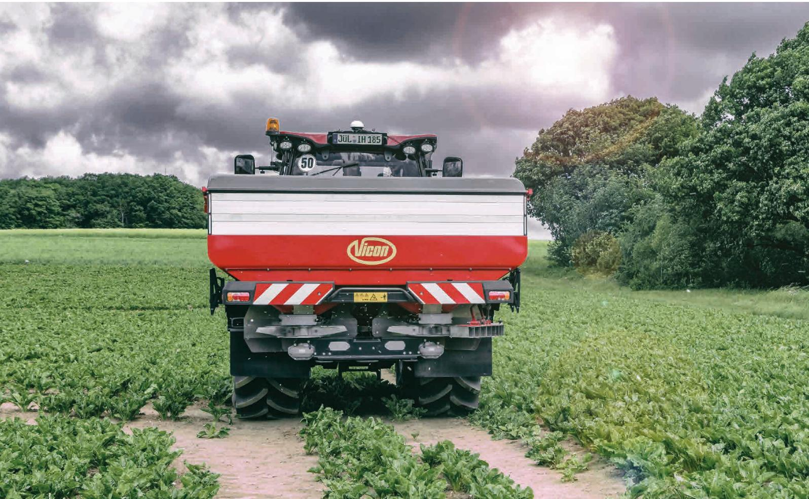
*Eine Grenzstreueinrichtung wird verwendet, um das Streubild von oder zu der Grenze eines Feldes hin zu optimieren, mit dem Ergebnis einer maximalen Verteilung innerhalb der Feldgrenzen, um einen optimalen Bestand zu gewährleisten, sowie einem minimalen Verlust ausserhalb der Feldgrenzen, um die Umweltbelastung zu minimieren.*
