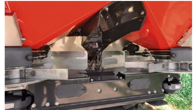
Ein elektrischer Stellmotor zur Steuerung der Ausbringmenge
