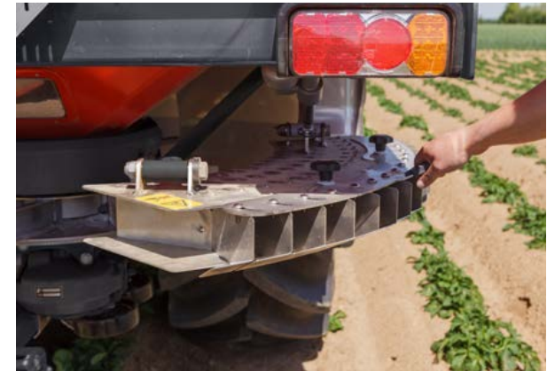
Aus der Fahrgasse - Streuen bis zum Feldrand mit ExactLine
