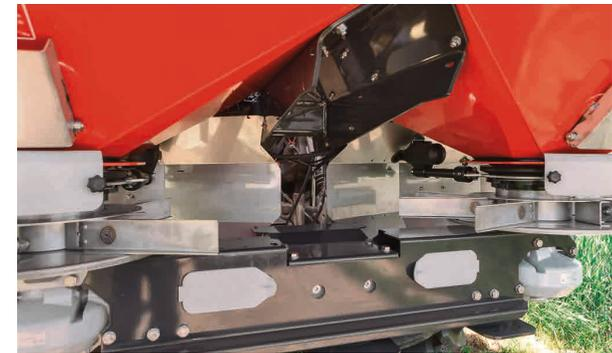
Ein elektrischer Stellmotor zur Steuerung der Ausbringmenge
