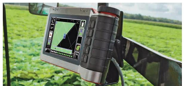
Durch Nutzung der variablen Applikationsmengensteuerung und automatischer Teilbreitenschaltung sparen Sie Düngemittel, Pflanzenschutzmittel und auch Saatgut. Mit zwei Bildschirmen ausgestattet haben Sie mit dem IsoMatch Tellus PRO die Möglichkeit, zwei Maschinen oder Vorgänge gleichzeitig zu überwachen.
