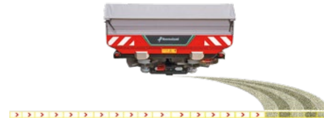
Отключение секций посередине и с одной стороны
