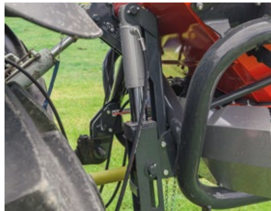
Разбрасывание по краю с помощью колесного цилиндра - разбрасывание в направлении к краю из последней технологической колее
