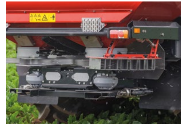
Разбрасывание по краю - разбрасывание в направлении к краю с помощью устройства ExactLine
