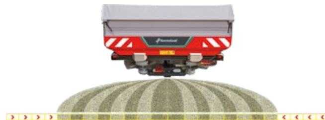
Уменьшение ширины разбрасывания с обеих сторон на 8 м
