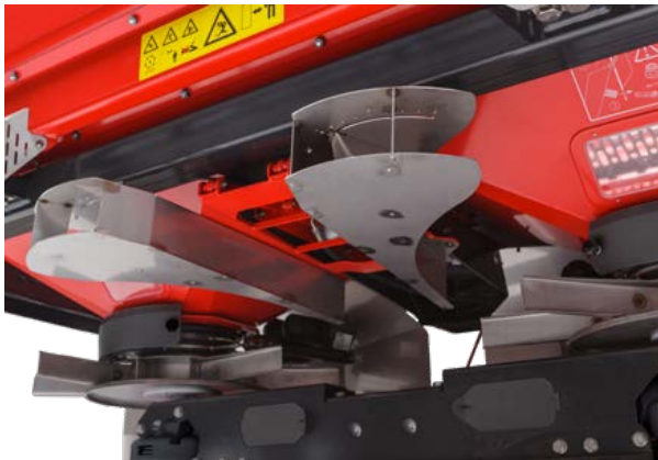
Одностороннее разбрасывание по краю - разбрасывание в направлении от края поля к центру с помощью ограничителя
