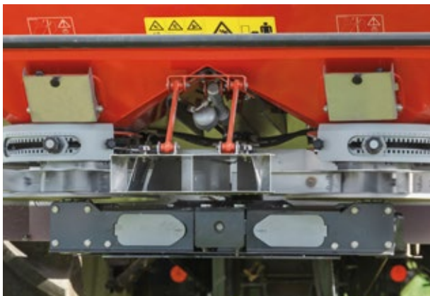
Одностороннее разбрасывание по краю - разбрасывание в направлении от края с помощью пластины для разбрасывания по краю
