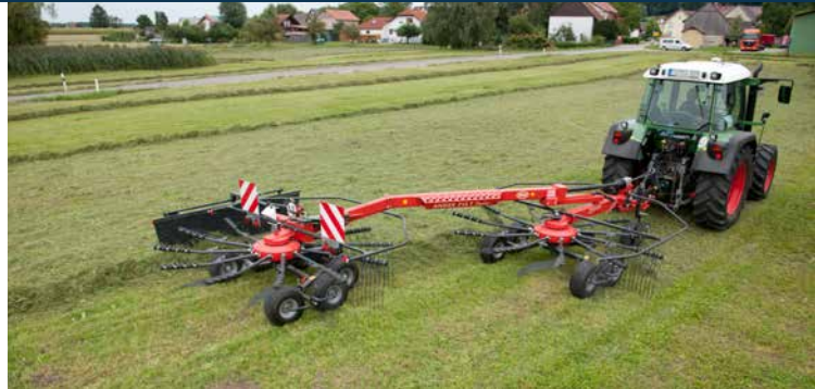
El 714T VARIO: 7,10 m de ancho de trabajo y sistema SideShift.
