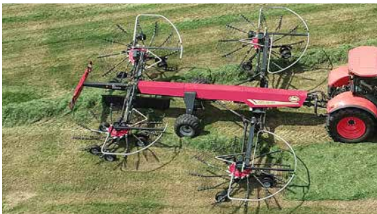
Vicon Andex 1304 Pro Elevación individual de los rotores.
