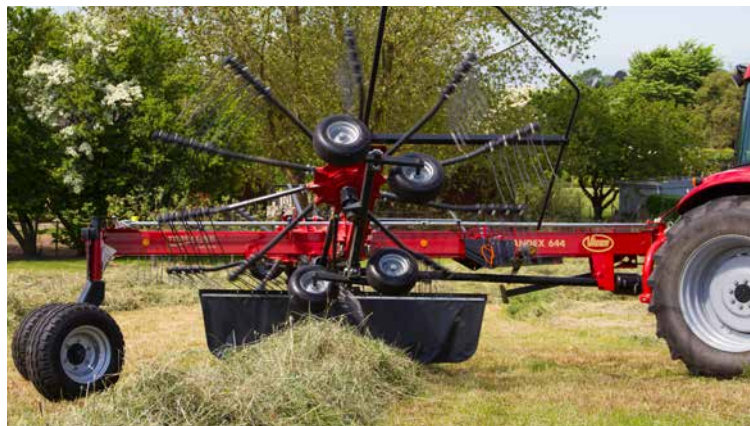
La altura del chasis proporciona una distancia al suelo excepcional en la cabecera.
