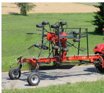
Los brazos se pueden retirar para limitar la altura de transporte. La tabla hileradora se pliega automáticamente.
