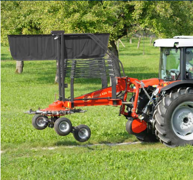
Para el transporte o el almacenamiento, las protecciones laterales se pliegan a lo largo del marco. Un resorte de asistencia montado en la tabla hileradora minimiza el esfuerzo de plegado.
