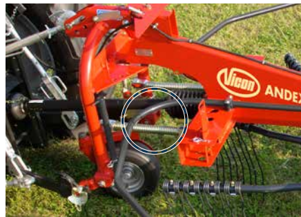
Los amortiguadores de oscilaciones aseguran una perfecta estabilidad del rastrillo.
