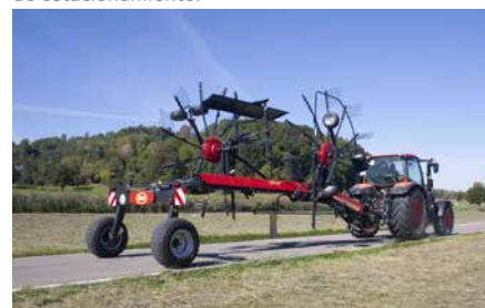
Altura de transporte inferior a 4m.
