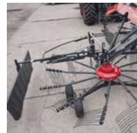
Plegado automático de la tabla hileradora y soporte de estacionamiento.
