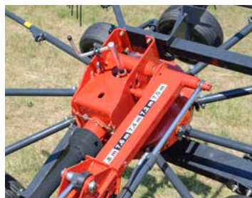
...a 7,80 m de ancho de trabajo con el AnDEX 764.
