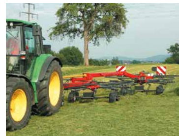
Desplazamiento lateral hacia la izquierda - para hacer hileras sin pasar por encima de los cultivos no rastrillados.
