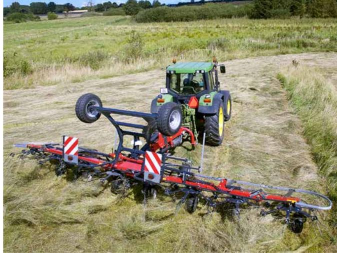
Aprovecha al máximo tu cosecha. Con la inclinación, se mantiene el cultivo dentro del campo. El henificador se coloca hidráulicamente en posición inclinada, fácilmente, para mantener el cultivo alejado del borde del campo.
