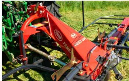
La robusta construcción de la unidad central en forma de V garantiza una gran estabilidad durante la henuficación y permite una gran velocidad de transporte.
