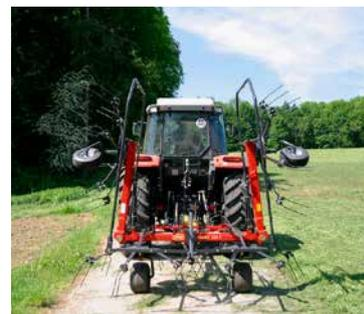
Durante el plegado hidráulico para el transporte, las púas se elevan automáticamente.
