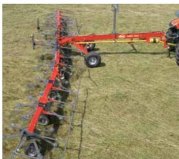
Los tres rotores exteriores pueden ser girados para el henificado de bordes con el fin de centrar el cultivo.
