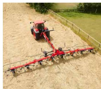
Conversión rápida y eficiente de la posición de transporte a la posición de trabajo.
