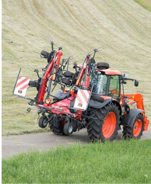
El Fanex 804 se pliega en una posición muy compacta para el transporte.
