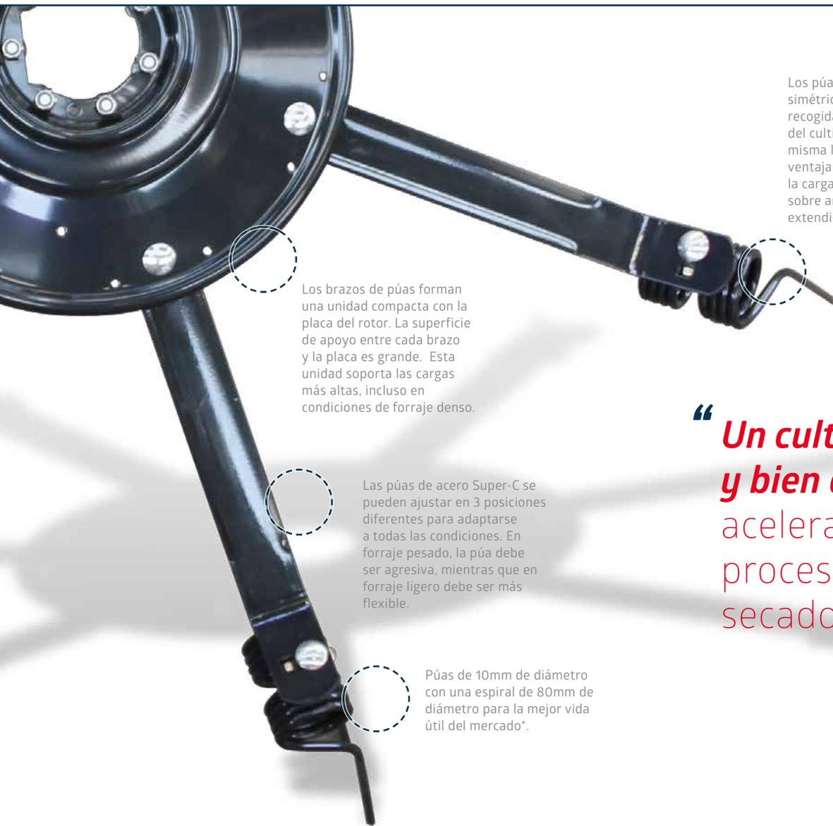
Los púas Super-C con púas simétricas garantizan una recogida y un giro eficientes del cultivo. Las púas de la misma longitud tienen la ventaja adicional de distribuir la carga uniformemente sobre ambos filamentos, extendiendo así su vida útil\*.
