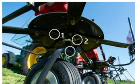
Fácil ajuste del ángulo de henificación gracias a un eje de 3 posiciones, sin necesidad de herramientas.
