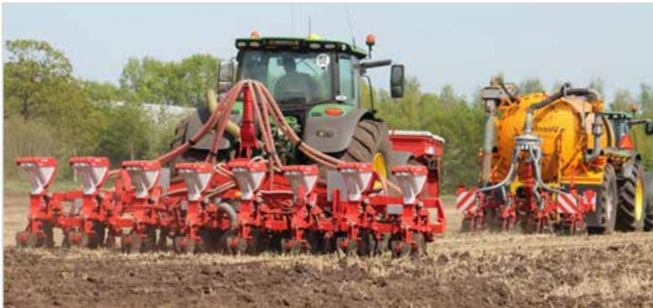
Durch den Einsatz von GEOCONTROL® entstehen keine Überlappungen. Kosten für Dünger, Saatgut und Pflanzenschutzmitteln werden gespart. Eine GPS-Steuerung des Schleppers ist zwingende Voraussetzung für das Strip-Till-Verfahren. Die Arbeitsbreite des Strip-Till Gerätes sollte am besten identisch oder maximal doppelt so groß sein, wie die der Einzelkornsämaschine.
