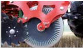
Die vorderen **Schneidscheiben** schneiden Ernterückstände und öffnen den Boden. Sie kann in der Arbeitstiefe verstellt werden.
