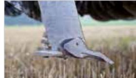
Spezielle **Zinken** mit **Schare** lockern den Boden bis in eine Tiefe von 10 bis 30 cm auf. Drei verschiedene Zinkentypen und eine hydraulische Überlastung schützen den Zinken. Für eine längere Lebensdauer ist eine Hartmetallversion erhältlich.
