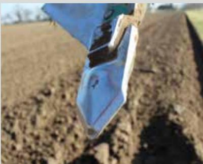
Das Kverneland Knock-on® System gewährleistet eine schnelle und einfache Handhabung beim Wechsel der Pflugspitzen. Und das bei einer längeren Standzeit als bei der bewährten Wechselfspitze.
