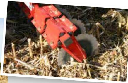
Maschine mit geringem Zugkraftbedarf. Die 450 mm großen Schneidscheiben durchschneiden die Stopeln und optimieren so den Erdfluss der danach folgenden zwei Zinkenreihen. Der CLC Pro Cut kann mit allen Walzen aus dem Kverneland Programm kombiniert werden.
