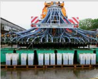
Die DLG hat die Längs- und Querverteilung des Profiline Fasses mit Euroject Schlitzinjektor auf Herz und Nieren geprüft. Das Ergebnis kann sich sehen lassen.
