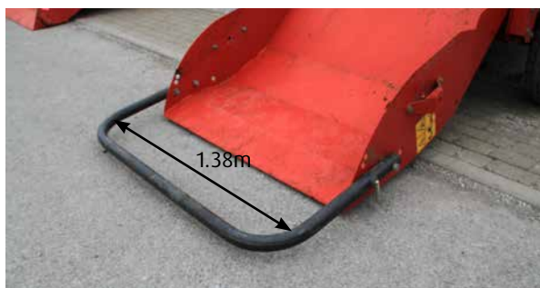
Széles kamraajtó kialakítás a bálák könnyebb rakodásához.
