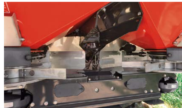
Elektromos működtetésű rendszer a kijuttatási mennyiség szabályozására
