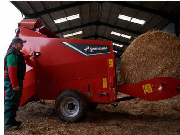
En plus du boîtier de commande situé à l'intérieur de la cabine du tracteur, le Kverneland 864 dispose d'une commande extérieure pour le convoyeur et la porte. La possibilité d'utiliser ces fonctions directement sur le côté de la machine permet de gagner un temps précieux lors du chargement.
