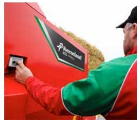
Actionner la porte arrière ainsi que le convoyeur à une distance sûre des organes en mouvement à l'aide de la commande placée sur le côté de la 853 Pro.
