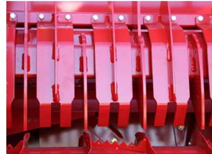
Le système DFCS engagé permet de réduire le risque de blocage pendant le chargement et le démarrage de la turbine.
