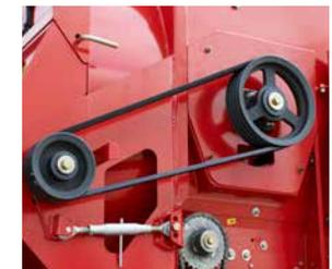
Entraînement par courroie : fonctionnement simple et entretien réduit.
