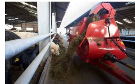
La goulotte pivotante à commande hydraulique fonctionne en 4 parties, permettant d'optimiser la distance paillage.
