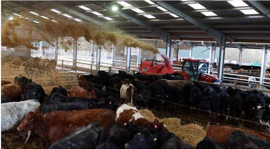
Une distance de projection allant jusqu'à 20 m, selon les conditions, assure une excellente capacité.
