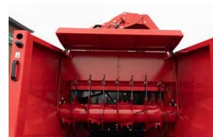
Peigne et protection supérieure à commande hydraulique.
