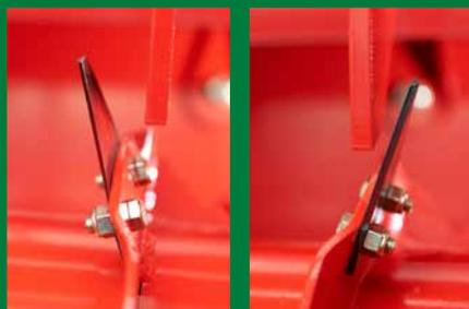
Un système breveté Kverneland - les couteaux passent les contre-couteaux sur des côtés différents pour une coupe plus régulière.
