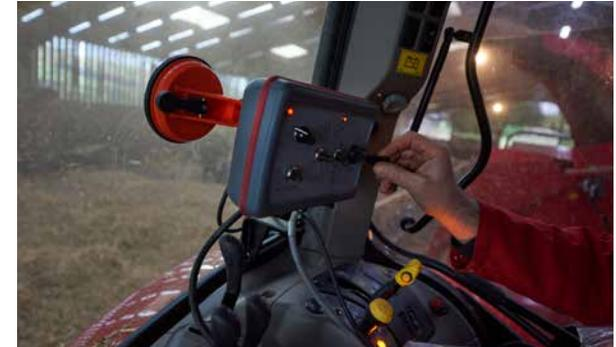
La goulotte pivotante à 4 positions est commandée par le joystick intuitif du boîtier de commande.
