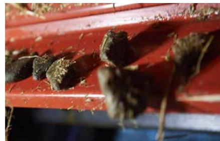
La Kverneland 864 est équipée d'une trappe à pierres intégrée placée à la base du convoyeur. Les corps étrangers sont séparés de la matière et facilement retirés par la suite.
