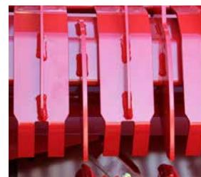
Le système DFCS engagé permet de réduire le risque de blocages lors du chargement et du démarrage de la turbine.
