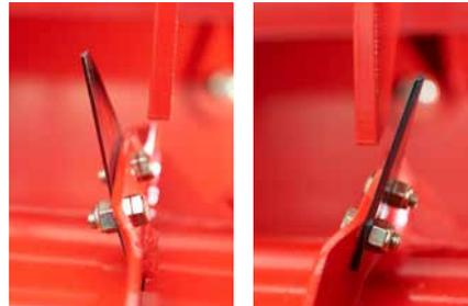
Un système breveté Kverneland - les **coupeaux passent les contre-coupeaux sur des côtés différents** pour une coupe plus régulière.
