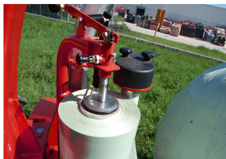
Simple sustitución de las bobinas.
