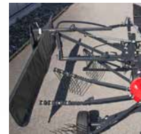
Chiusura automatica dei deflettori di andana con dispositivo di parcheggio.
