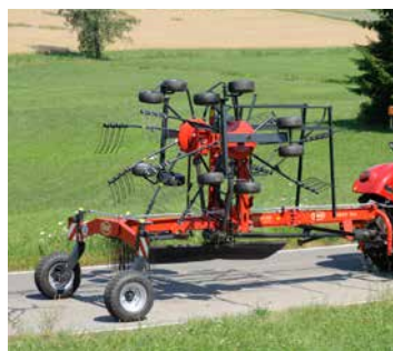
Per ridurre ulteriormente l'altezza di trasporto le braccia portadenti possono essere rimossi dal modello Andex 764.
