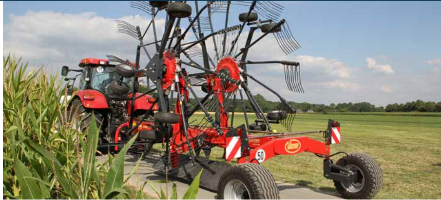
9.00m di larghezza di lavoro e trasporto sotto i 4m anche senza staccare le braccia...
