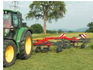
Movimento SideShift verso sinistra per evitare che la macchina calpesti l'andana.
