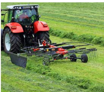
AnDEX 474T - Larghezza di lavoro da 4,70m ad un peso di soli 665kg.
