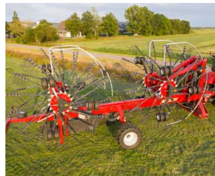
Con il suo esclusivo sistema di ripiegamento, la macchina non supera i 4m di altezza. Non è necessario rimuovere le braccia portadenti durante il trasporto.
