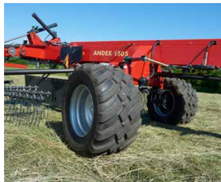
L'assale sterzante automatico (optional), garantisce un'eccellente manovrabilità.
