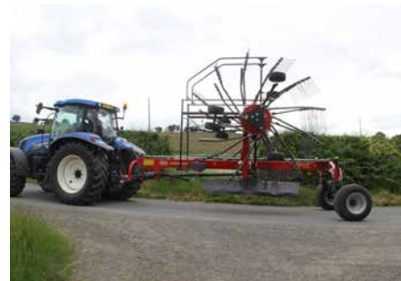
An dex 804 riduce l'altezza di trasporto sotto i 4m permettendo così al driver di non smontare le braccia.
