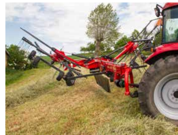
Sterzo attivo delle ruote e curve curve fino a 80°.
