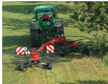
Spostamento 'SideShift' del rotore verso destra per evitare gli alberi.
