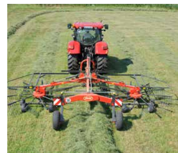
Gli andanatori Andex multirotore si adattano perfettamente al terreno grazie alla funzione TerraLink Quattro ad eccezione del modello 644.
