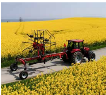
Semplice conversione da posizione di lavoro in quella di trasporto azionata dalla cabina del trattore.
