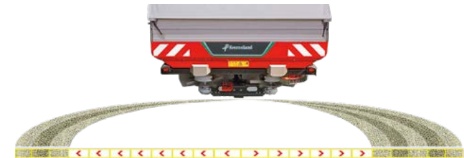
Disattivazione delle sezioni dal centro verso l'esterno
