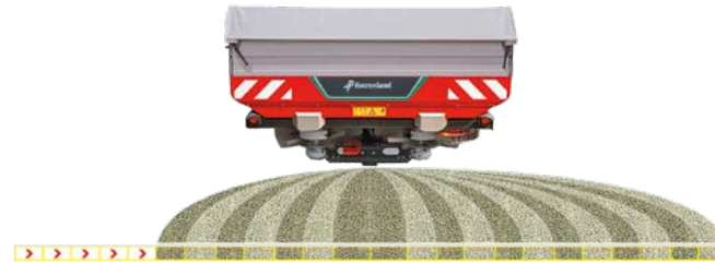
Riduzione della larghezza di spandimento sul lato sinistro di 10 m
