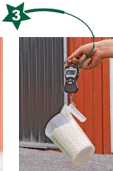
3 Determina il peso specifico
