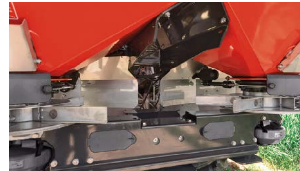
Un attuttore elettrico per controllare il tasso di distribuzione
