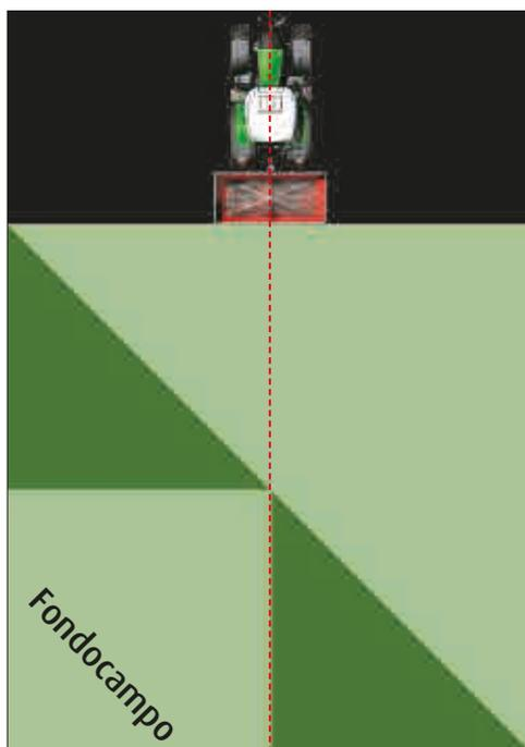
**Controllo delle sezioni base - 4m per sezione**
