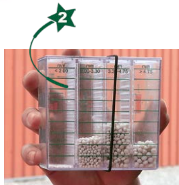
2 Determina la tipologia e la distribuzione del granulo
