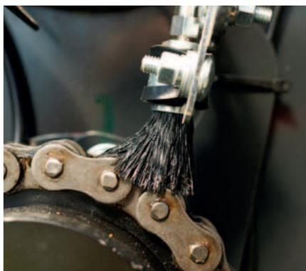
La lubrificazione automatica delle catene è standard e viene attivata programmando il flusso su ogni catena a seconda della loro dimensione.
