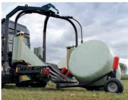
E' disponibile, in opzione, il kit bale-on-end. Durante il trasporto questo kit viene ripiegato automaticamente in posizione di sicurezza all'interno dell'unità di avvolgimento.
