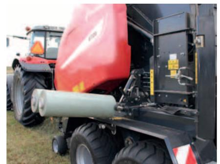
I rulli porta film vengono abbassati idraulicamente per una facile e rapida sostituzione dei rotoli.
