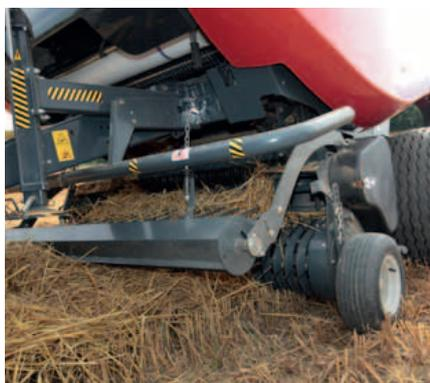
Il rullo pressatore di ampio diametro pre-comprime il prodotto in modo da agevolare l'entrata nella camera di pressatura. Il rischio di ingolfamenti viene ridotto, mentre la velocità di introduzione aumenta.
