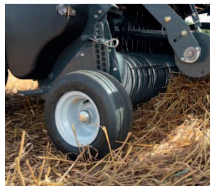
Le ruote del pick-up sono formate da pneumatici a bassa compattazione. La struttura compatta del pick-up fa sì che le ruote rientrino nella larghezza della rotopressa; in questo modo non si dovrà rimuoverle per il trasporto.
