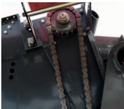
La trasmissione alla camera di pressatura avviene tramite una catena da 1 1/4" a bassa manutenzione, per una grande longevità della macchina.
