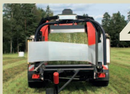
Il processo di fasciatura inizia simultaneamente velocizzando il lavoro.
