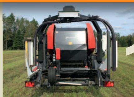
Una volta che la rete è applicata alla balla, la piattaforma di avvolgimento si sposta al portellone della rotopressa per iniziare l'avvolgimento successivo.
