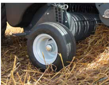
Ruote maggiorate d'appoggio con semplice regolazione dell'altezza di lavoro.
