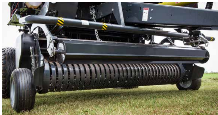
Deflettore a rullo di ampio diametro per un flusso facilitato del prodotto ad alte velocità.
