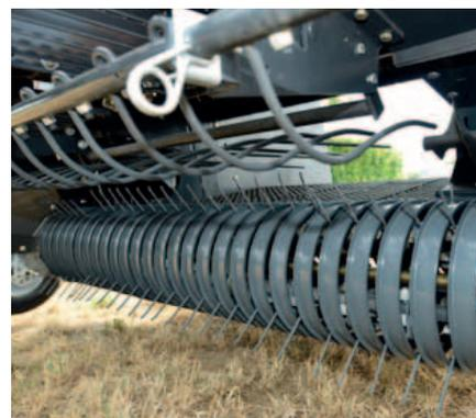
Cinematismo con angolo dei denti più aggressivo, per permettere un avanzamento più rapido; 2 coclee laterali di grande diametro guidano attivamente il prodotto fino all'interno della camera, agevolando il lavoro su andane di grandi dimensioni; raccogliitore di piccolo diametro, dotato di due ruotini.
