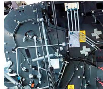
Circuitos hidráulicos de tubos rígidos de acero.
