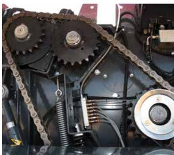
Los accionamientos de la cámara principal están provistos de una cadena de 1"  $\frac{3}{4}$  para una mayor duración y un mantenimiento reducido.
