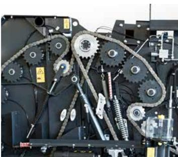
La cámara principal es accionada por una cadena de 1" ¼ para una mayor duración y un mantenimiento reducido.
