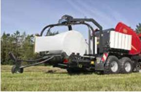
Encintadora de doble satélite con dos pre-tensores y cuatro cintas sin fin para un encintado rápido y fiable.
