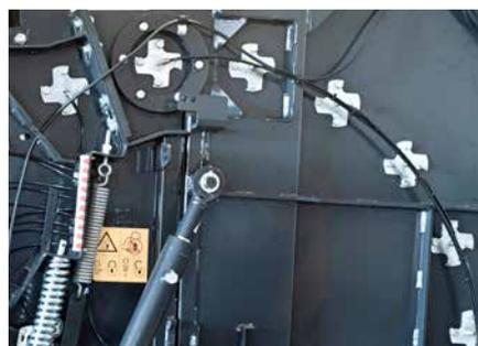
Todos los rodillos están montados sobre cojinetes engrasables de alta resistencia. El mantenimiento de los rodamientos se realiza fácilmente desde los bancos de lubricación centralizados.
