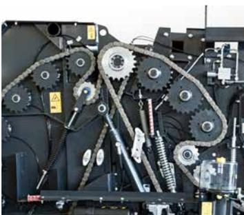
L'entraînement de la chambre principale est assuré par une chaîne de 1" ¼ pour une durée de vie plus longue et une maintenance réduite.
