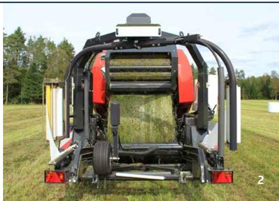
2 La balle est déposée directement sur la table d'enrubannage.
