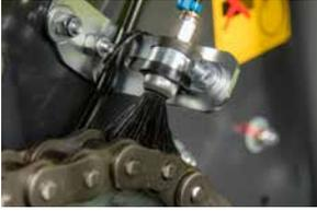
La lubrification automatique des chaînes en standard sur RF4225 Plus.
