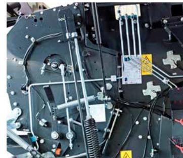
Circuits hydrauliques en tubes rigides en acier.
