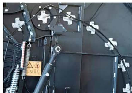
Tous les rouleaux sont montés sur des roulements graissables et résistants. L'entretien des roulements s'effectue facilement à partir de banques de graissage centralisées.
