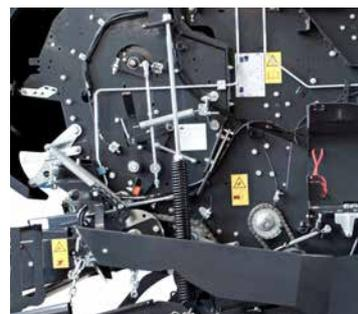
Circuits hydrauliques avec tubes rigides.
