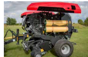
Zwei serienmäßige Netzrollenhalter für lange Arbeitstage
