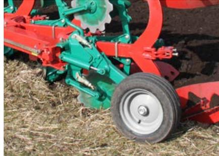
**Hinten angebautes Stützrad mit Teleskoparm**
