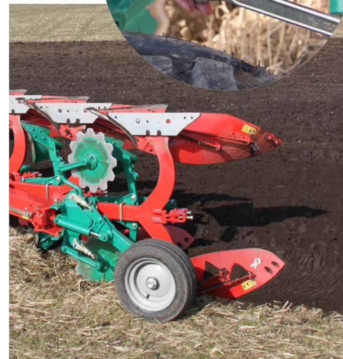
Einfache und schnelle Einstellung der Arbeitstiefe mit Y-Schrauben
