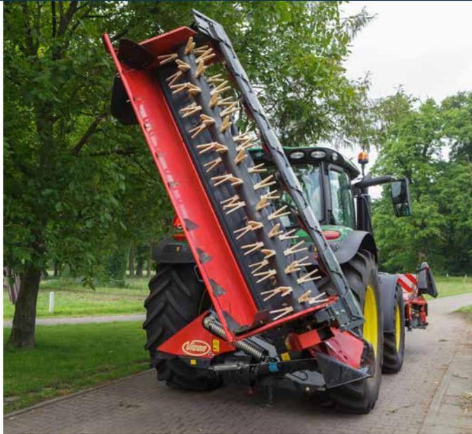
Un cilindro hidráulico permite elevar las segadoras EXTRA 624T, 628T/R y 632T Farmer hasta 125° en la posición de transporte.
