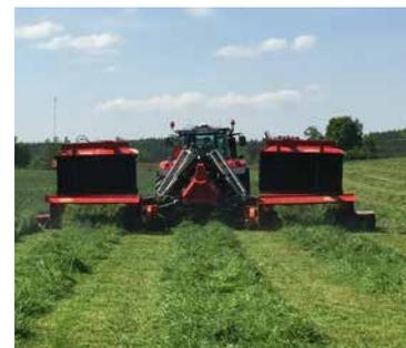
Cuando no se utiliza, la cinta se eleva hidráulicamente por encima del mecanismo de corte. Todo lo que tiene que hacer es presionar el botón en la caja de control.
