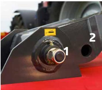
Dos posiciones de montaje de la barra de corte para un solapamiento óptimo.
