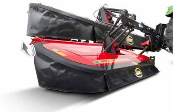
Seguridad Non-Stop - En caso de un obstáculo, la segadora se mueve hacia atrás y luego se levanta, incluso en la parte interior de la segadora, y luego regresa a la posición de trabajo una vez que se ha pasado el obstáculo. No se requiere un tiempo de inactividad - no hay pérdida de tiempo.
