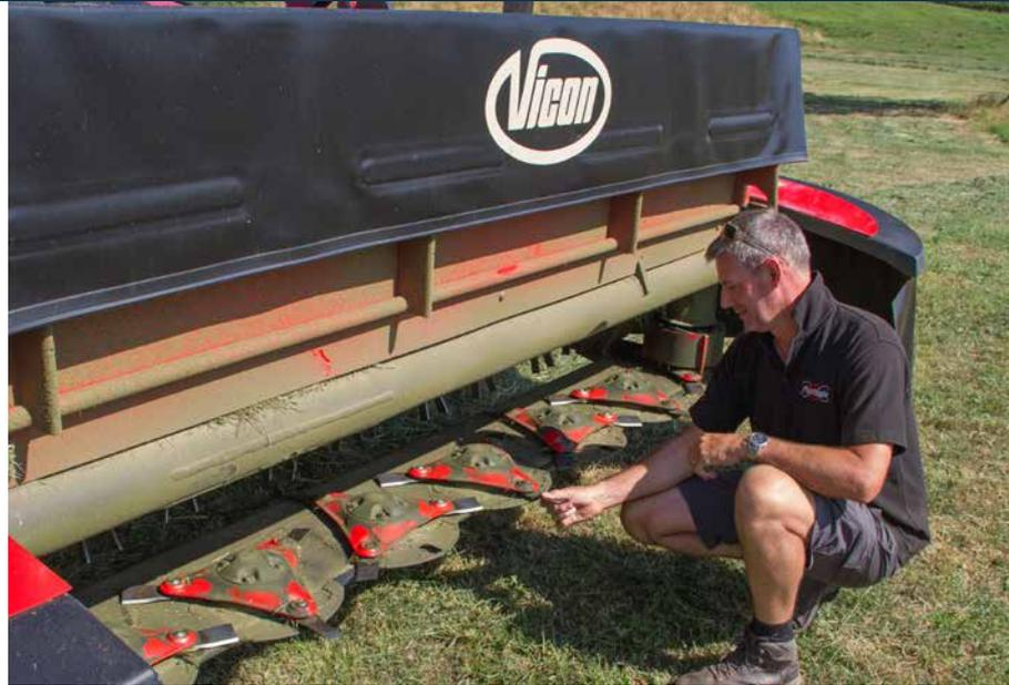
La cubierta frontal se abre en posición vertical para facilitar el acceso.
