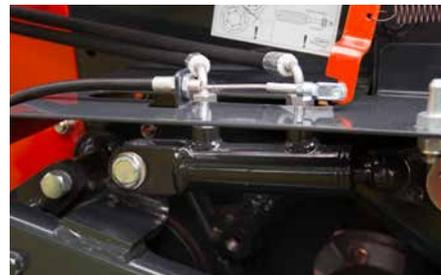
Con el cilindro hidráulico opcional, la presión y la distancia entre los rodillos se pueden ajustar fácilmente.
