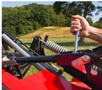
El ajuste de la altura de corte está integrado directamente en el sistema de suspensión.
