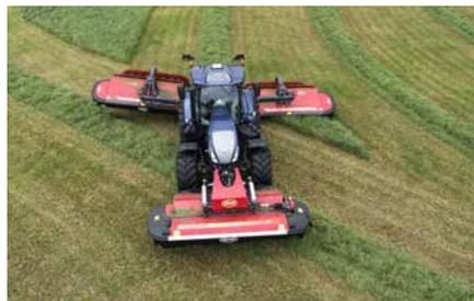
Cuando se utiliza una sola cinta, la velocidad se reduce para evitar que el cultivo sea lanzado demasiado lejos en el centro.
