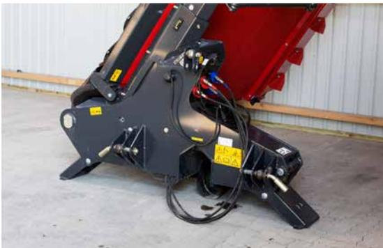
Cuando la segadora está aparcada o durante el almacenamiento invernal, las barras de tracción del tractor están siempre en posición horizontal, lo que facilita el enganche y desenganche de la segadora del tractor.
