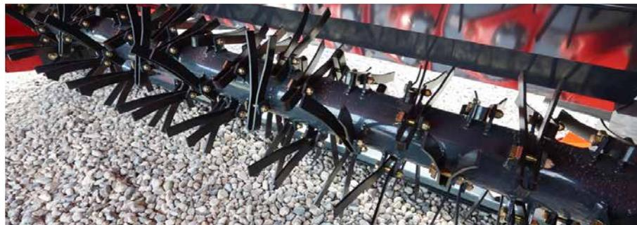
Los dedos de acero permanecerán en una posición fija durante todo el proceso para un acondicionamiento óptimo.
