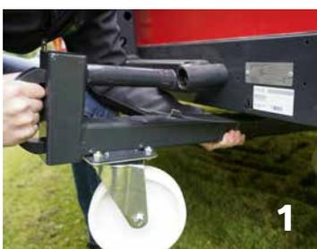
Deslice las ruedas de transporte suministradas en la cinta BX y retire el pasador de conexión.
