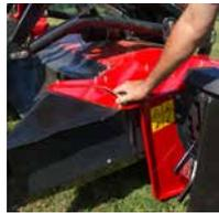
Chapas hileradoras integradas, fácilmente ajustables para corregir el ancho de hilera.
