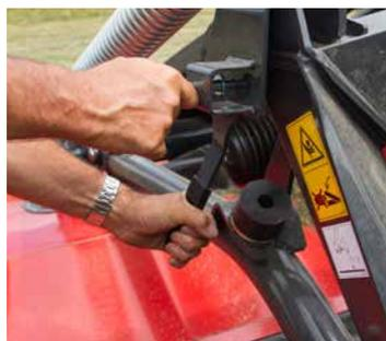
Soporte de estacionamiento con una manija para bloquear y preparar la máquina para el desacoplamiento.
