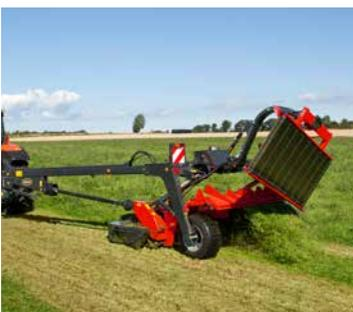
Cuando se hace la primera hilera, la cinta transportadora se sube y baja hidráulicamente para hacer la segunda hilera.
