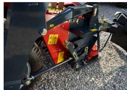
La barra de suspensión especial se encarga de que la barra de corte se levante automáticamente hacia arriba y por encima del objeto.
