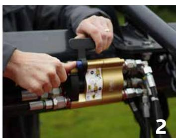
Desconecte el cable de alimentación y todas las conexiones hidráulicas de la cinta BX con una sola palanca.
