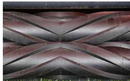
La forma en chevron de los rodillos garantiza un flujo uniforme del forraje en todo el ancho de trabajo.
