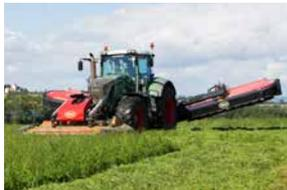
Ajuste la altura de elevación en la cabecera. En condiciones de baja densidad de cultivo, se puede reducir la altura de elevación de las segadoras.
