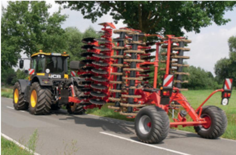
Простое преобразование из рабочего положения в транспортное.
