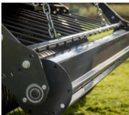
Il deflettore, con rullo di grande diametro, pre-comprime l'andana e assicura un flusso di prodotto regolare, permettendo una velocità di avanzamento maggiore.
