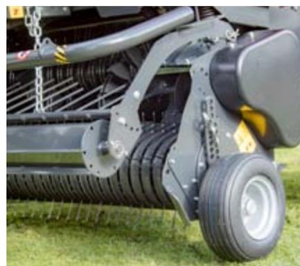
Ruotini del raccoglitore con pneumatici larghi per un buon 'galleggiamento' in fase di lavoro. L'esclusivo sistema di trasmissione permette di mantenere i ruotini entro la larghezza complessiva della macchina, eliminando la necessità di rimuoverli per trasporto su strada.
