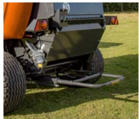
L'allontanatore, disponibile come opzione, permette alla palla di rotolare al di fuori del raggio d'azione del portellone, così da evitare di retrocedere una volta completata la palla.
