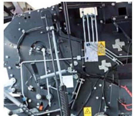
Impianto idraulico con tubi rigidi.
