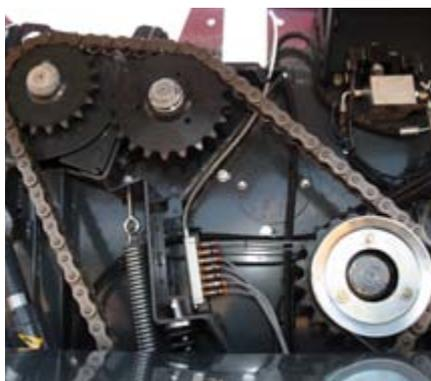
**La catena di trasmissione principale è da 1"1/4 per una maggiore durata e ridotta manutenzione.**
