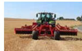
Semplice conversione da lavoro a trasporto. Le due parti a chiusura idraulica permettono una larghezza di trasporto di 2.55m nel modello portato e 2.75 nel modello trainato. Le sospensioni idrauliche assicurano il buon funzionamento e trasporto sicuro su strada.
