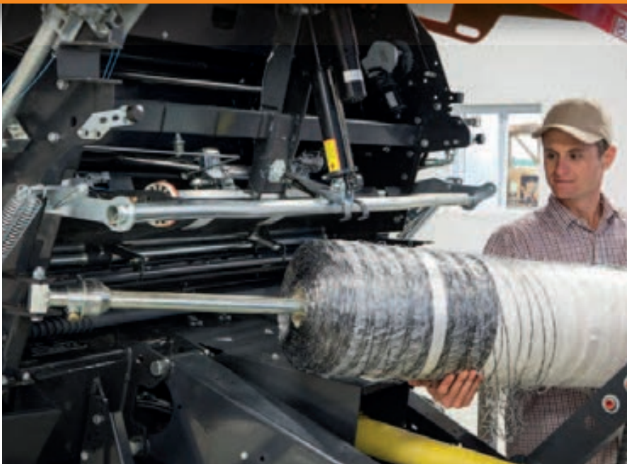
Den låga lasthöjden gör det enkelt att montera nätrullen, vilket innebär minimal tid till förberedelser och maximal tid till pressning.
