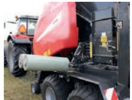
Filmrullehållaren sänks med hydraulik för enkelt byte.
