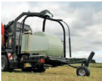
Dubbel satellitinplastare med 2 försträckare och 4 drivremmar för snabb och stabil inplastning.
