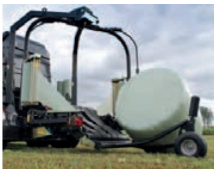
Balställare är standard. Under transport är denna funktion automatiskt satt i säkrat läge inuti plastningsenheten.
