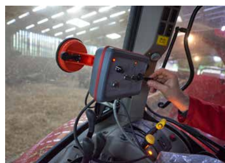
Der Schwanenhalsauswurf wird mit einem Joystick gesteuert.
