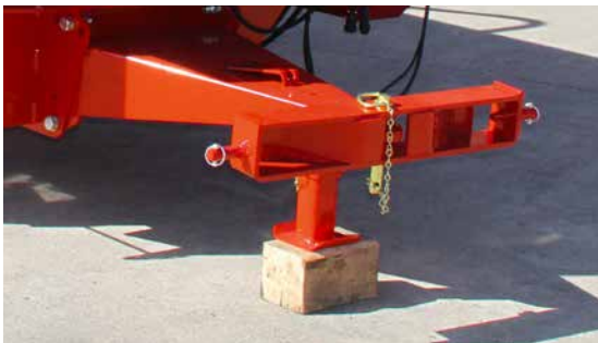
Unterlenkeranhängung für enge Kurvenfahrten
