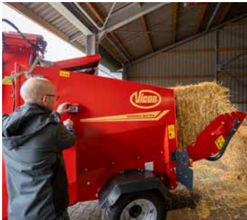
Sicheres Bedienen von Heckklappe und Kratzboden mit der seitlich angebrachten Fernbedienung
