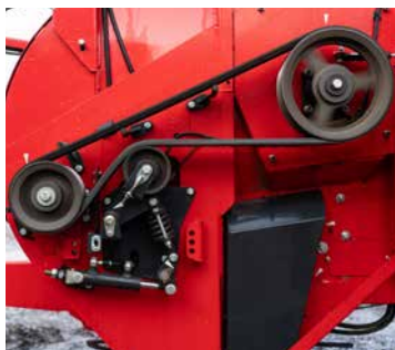
Hydraulische Zuschaltung der Fräßwalzen, damit das Schwungrad vor Materialzufuhr auf Drehzahl gebracht werden kann.
