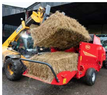
Der Shredex 866 Pro hat eine offen gestaltete Ballenkammer für einfachen Zugang beim Beladen von oben.
