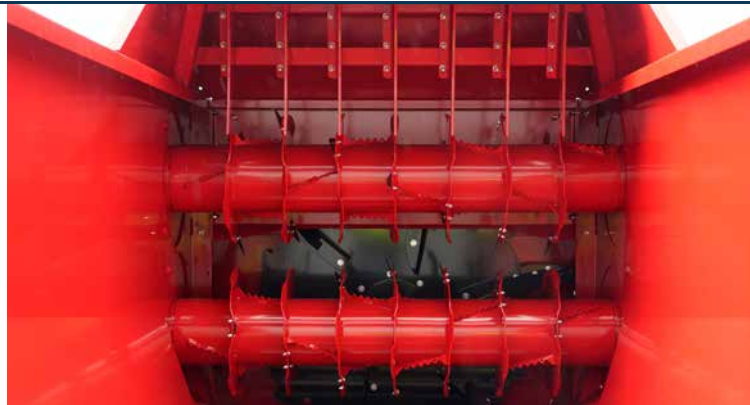
Zwei Fräßwalzen für die Verarbeitung großer Materialmengen
