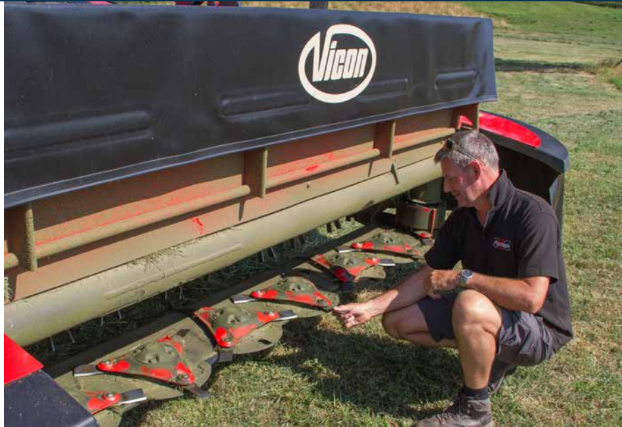
De frontkap kan verticaal omhoog klappen voor eenvoudige toegang.
