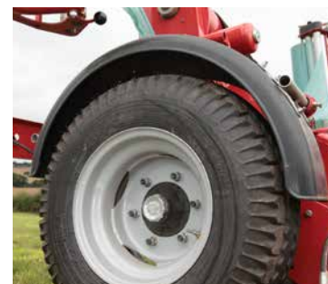
Die Kotflügel reduzieren die Verschmutzung an den Vorstreckern und Folienrollen.
