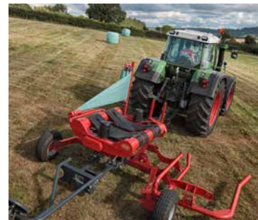
Der Drehtisch mit zwei angetriebenen Rollen ist für schwere Ballen und eine gleichmäßige Ballenrotation ausgelegt.
