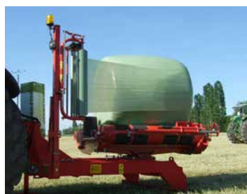
Vier Endlosriemen drehen den Ballen gleichmäßig während des Wickelns.
