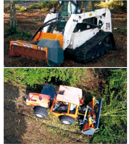
Forestmaster - Špeciálny drvič drevnej hmoty do priemeru 10cm, sa stranovým posuvom.
