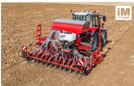
**Пневматическая навесная сеялка e-drill maxi plus**
