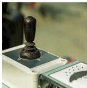
Все модели компьютеров оснащены компактным электронным джойстиком, который может быть установлен на подлокотнике трактора, что позволяет в любой момент времени запускать функции обмотки и опрокидывания тюков пальцами, а также мгновенного ручного управления другими функциями.
