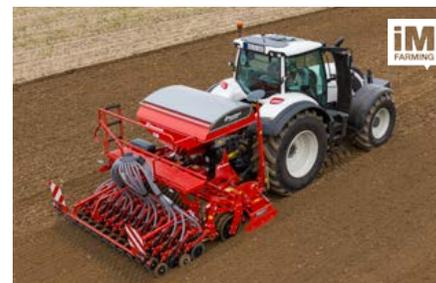
**Пневматическая навесная сеялка e-drill**
