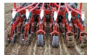
Задельвающие катки повторно уплотняют почву. Три различных типа заделывающих катков позволяют адаптироваться к изменчивым условиям почвы.
