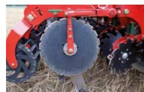
Боковые лезвия удерживают рыхлый грунт в пределах полосы, а также определяют ширину и форму полосы.
